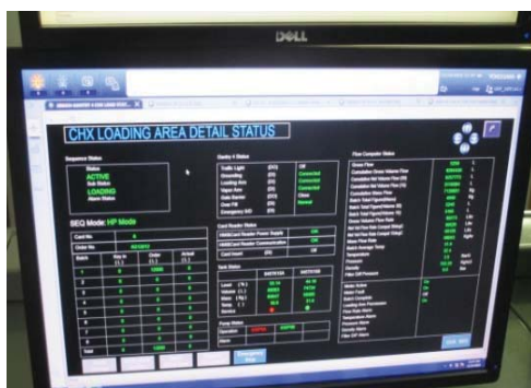
รูปที่ 5 หน้าจอควบคุมระบบไอ สารไฮโดรคาร์บอนด้วยโปรแกรม PLC
