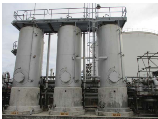
รูปที่ 71 Vapor Recovery Unit
