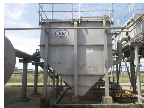
รูปที่ 16 CPI Separator
